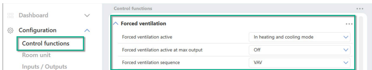
Bild 2-36 Konfigurationseinstellungen Zwangslüftung im Application Tool 2
