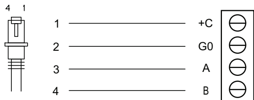
Fig. 1 Raccordement câble (Code de couleur EDSP-Kx: 1=Noir, 2=Blanc, 3=Jaune, 4=Marron)
